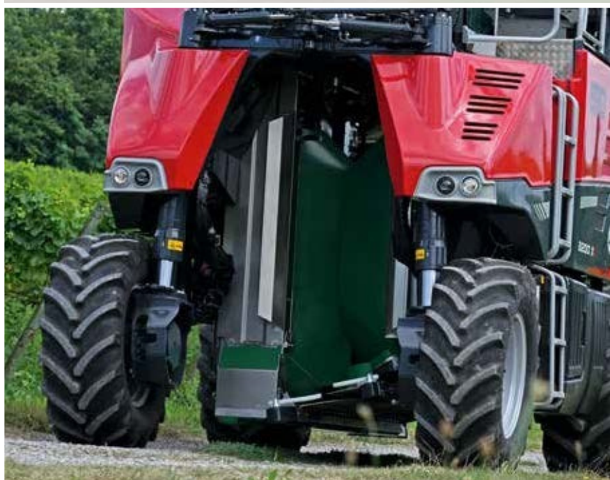
Odpružená přední náprava zvyšuje jízdní komfort a zajišťuje bezpečnou jízdu i na nezpevněných cestách.
