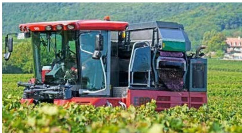
Odstopkovač stroj propustí do hroznové nádrže pouze ty nejlepší hrozny.
