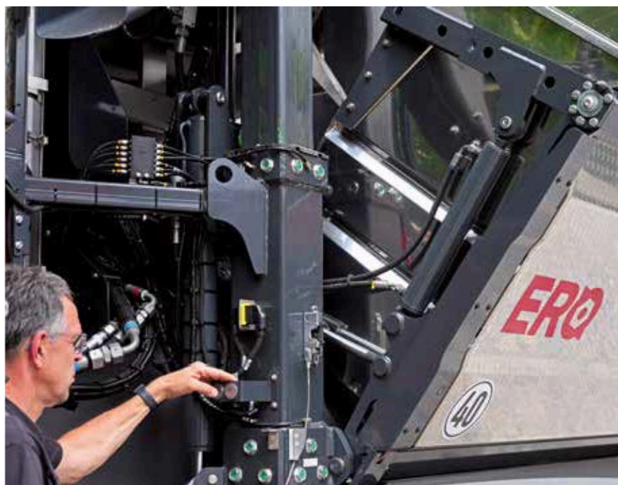
Při mytí stroje lze nádrž na hrozny vyprázdnit pomocí snadno přístupných tlačítek připevněných k rámu.
