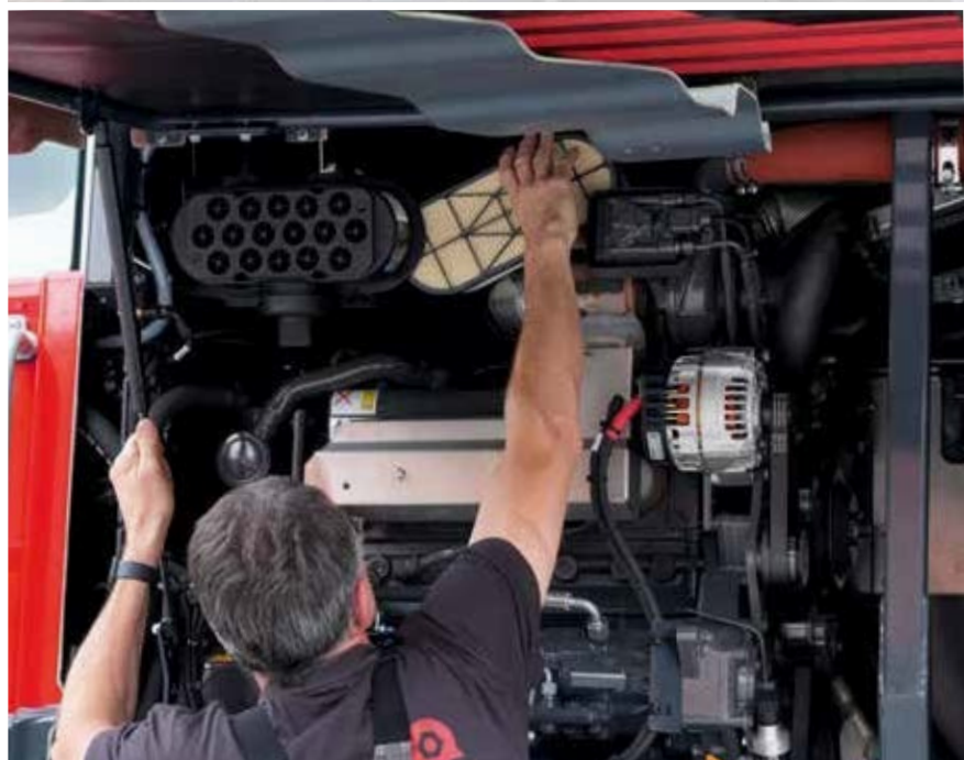
Vzduchový filtr lze vyměnit jedním jednoduchým pohybem.
