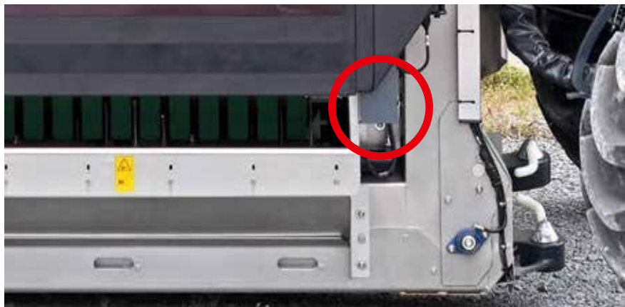
Zobrazení výšky pomocí ultrazvukového senzoru.
