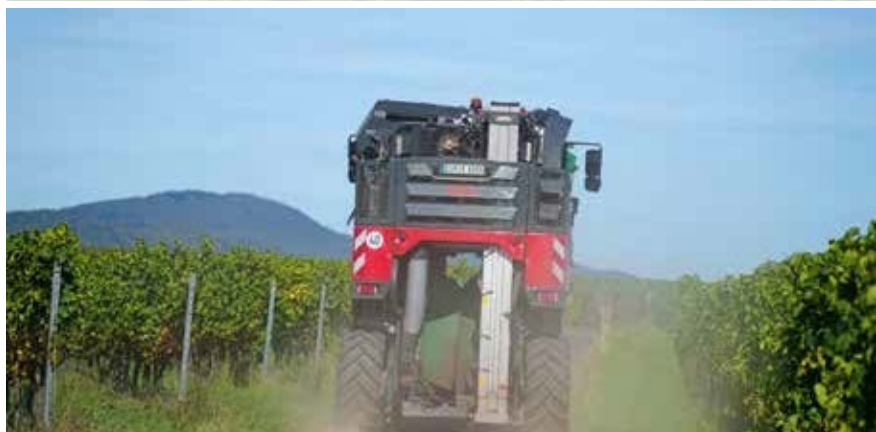
Nožní brzda na všech čtyřech kolech zajišťuje krátkou brzdovou dráhu i při maximální rychlosti.
