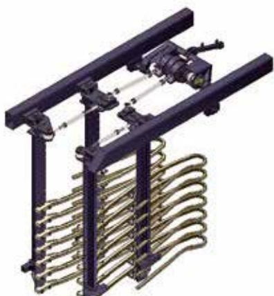
Setřásací mechanismus: Flexibilitu setřásadel lze individuálně nastavit.
