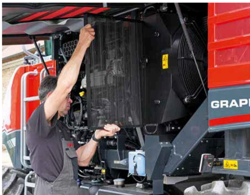
Všechny údržbářské díly na motoru jsou přístupné z jedné strany.
