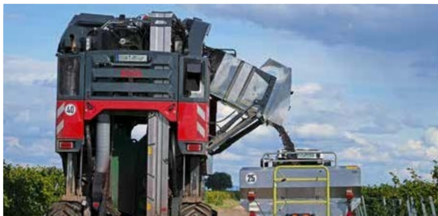
Boční vysypávání nabízí dobrý výhled a ve srovnání se zadním vysypáváním trvá jen asi třetinu času.
