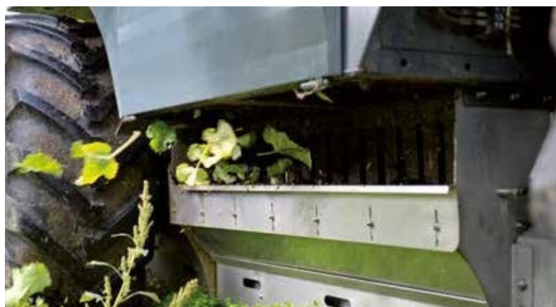
Shrabovače listů a trysky s křížovým ventilátorem odstraňují listy dříve, než se dostane do kontaktu s hroznem.
