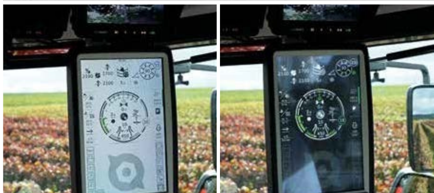
Systém regulace rychlosti zajišťuje konstantní rychlost sklizně. Intuitivní displej nabízí denní a noční režim.
