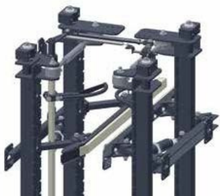
Navádění a detekce sloupků s automatickým vypnutím setřásadel umožňuje sklizeň ve vinicích s betonovými sloupky.
